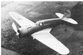
Prototyp H-75 absolvoval většinu zkoušek s motorem Twin Wasp Junior. Typickým znakem tehdejších konstrukcí byla možnost zaměřovat pohonné jednotky. V případě Hawku 75 používaly hvězdicové motory Cyclone a Twin Wasp, zkusily se i motory řadové.
